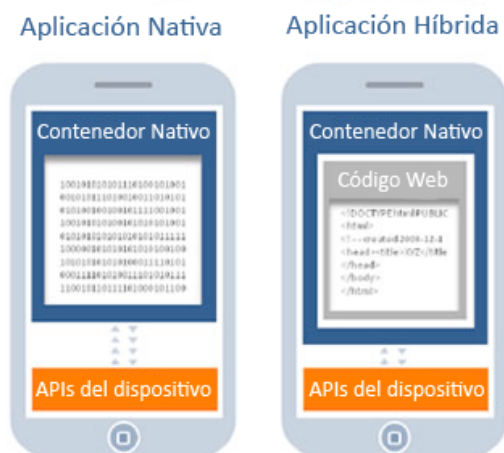
Ilustración 9. Diagrama de interacción de aplicaciones nativas e híbridas con los APIs del dispositivo.
